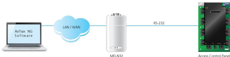
La distance maximale entre le port Ethernet de la centrale et la connexion LAN/WAN est de 99.97 m.
